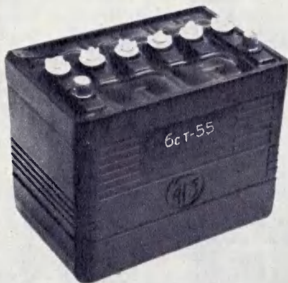
6СТ-55 — самая распространенная батарея для легковых автомобилей.
